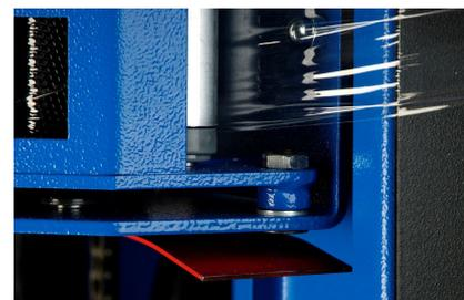
Sicherheitseinrichtung am Hubschlitten
